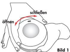
Der Melder muss auf einen ebenen, festen Untergrund montiert werden. Vor der Montage muss der Abdeckring entfernt werden. Dazu ist der Abdeckring beim PD2 entgegen dem Uhrzeigersinn um ca. 5° zu drehen und abzunehmen.
