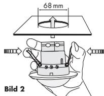
In der Decke muss zuerst eine runde Öffnung mit 68 mm Durchmesser erstellt werden. Nach dem vorschriftsgemässen Anschluss der Kabel wird der Melder in die vorhandene Öffnung eingeführt und durch die Federklammern fixiert (siehe Bild 2).
